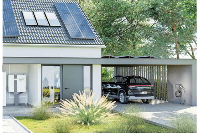
*Eine intelligente Kombination aus Photovoltaikanlage, Speicher und Wallbox sorgt dafür, dass das E-Auto beinahe komplett aus der Kraft der Sonne geladen werden kann.*
