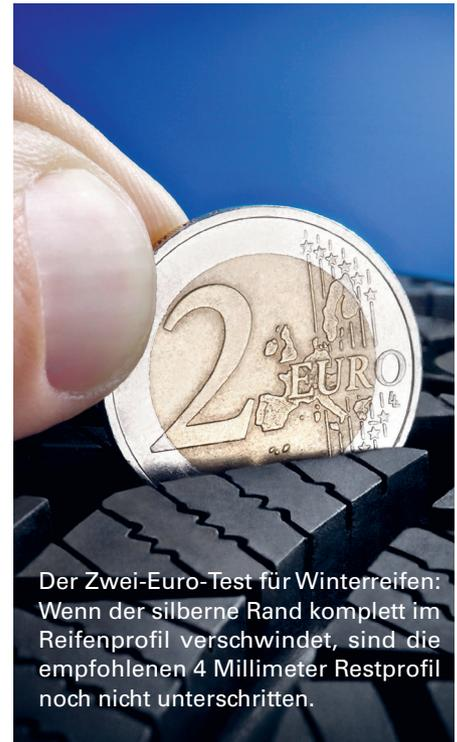
**Der Zwei-Euro-Test für Winterreifen:** Wenn der silberne Rand komplett im Reifenprofil verschwindet, sind die empfohlenen 4 Millimeter Restprofil noch nicht unterschritten.
