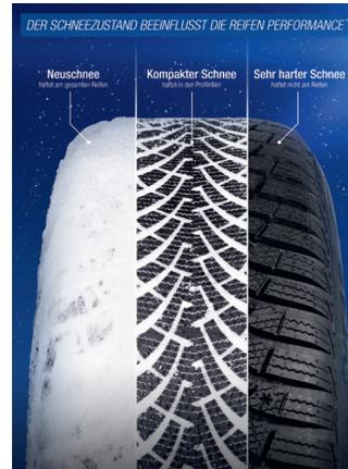
Lockerer Pulverschnee bleibt stärker am Reifen haften als verdichteter Schnee.
