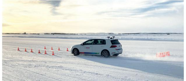
Die weiten Flächen in Nordskandinavien bieten sehr gute Voraussetzungen dafür, Bremsregelsysteme wie das neueste Elektronische Stabilitätsprogramm ESP intensiv zu prüfen.
